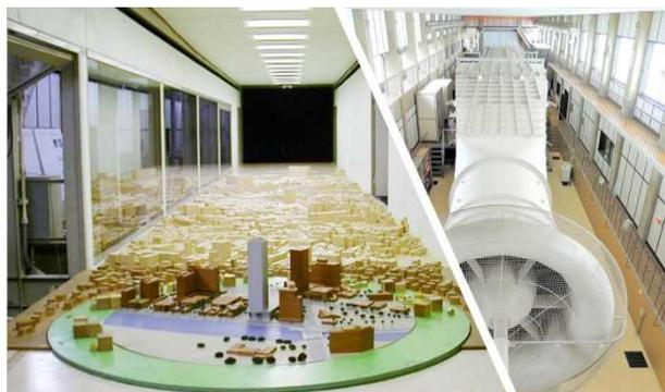
風洞内の被測定建物と気流発生ファン外観
